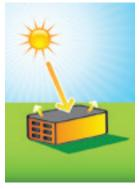
Temperatura con membrana impermeabile nera Superficie della copertura = 80 °C Temperatura interna = 30 °C
